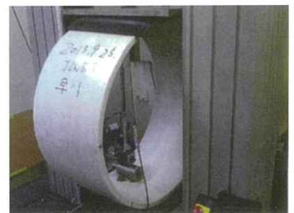
外圧試験状況
